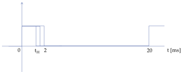
Fig. 4. Diagrama temporal do sinal de controle de um servo-motor
