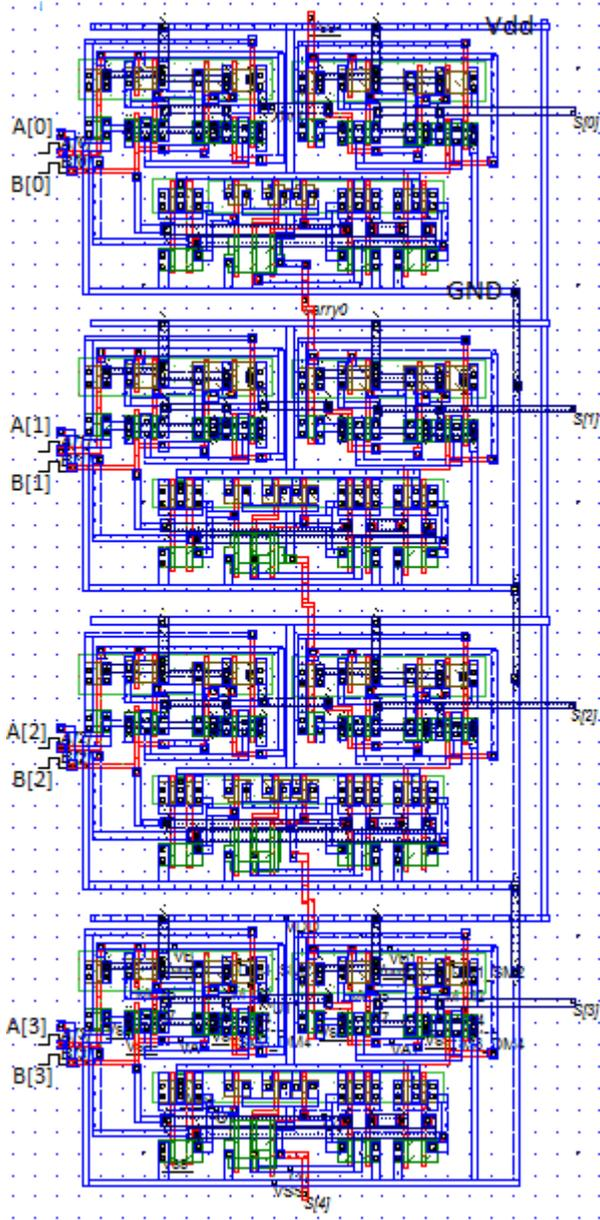
Fig. 2. ADD4 Layout Design - Column Orientation
